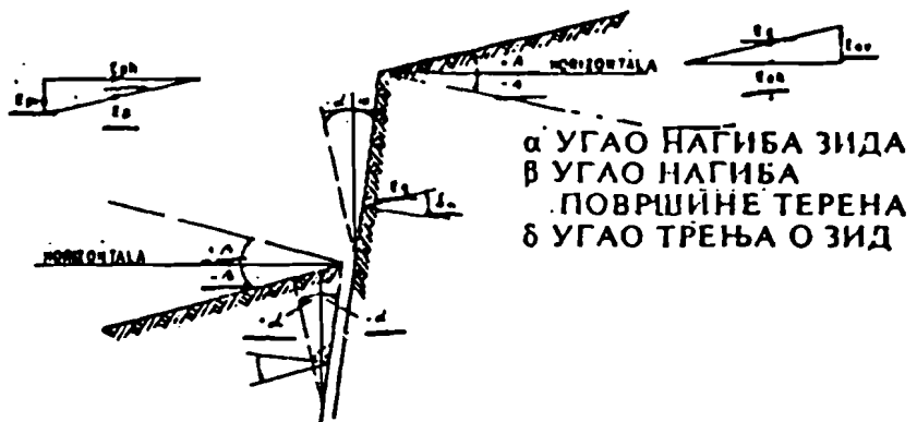
Slika 2 - Pravila predznaka uglova za proračun aktivnog i pasivnog pritiska zemlje
